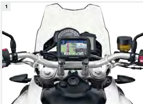
**КРОНШТЕЙН ДЛЯ КРЕПЛЕНИЯ НАВИГАЦИОННЫХ УСТРОЙСТВ BMW MOTORRAD**
