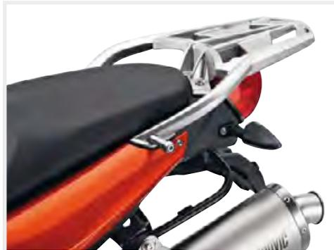
**ДУГИ ДЛЯ КРЕПЛЕНИЯ БАГАЖНОЙ СИСТЕМЫ**
