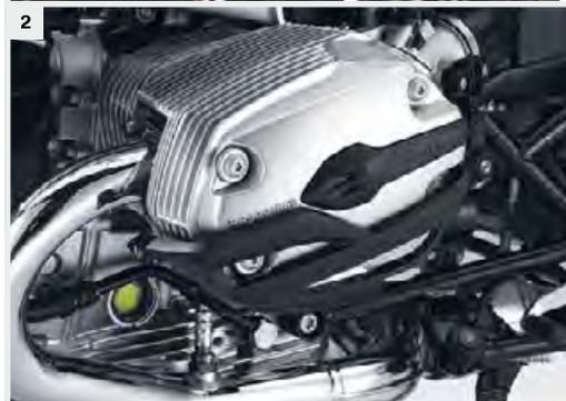
**Пластиковая защита крышек цилиндров** (изображение 2)
